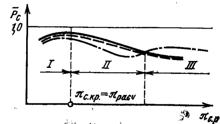
Рис. 6.10. Тяговые характеристики сужающегося сопла и дозвуковых выходных устройств в условиях старта:
